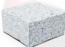
*«Карандаш» обладает пилеными, ровными боковыми поверхностями, что обеспечивает геометрически точную укладку. Верхняя и нижняя поверхность колотые, обладают неровностями. Используется для мощения парковок, въездах на прилегающую территорию.*
